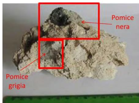
Fig. 7- Materiale campionato, in evidenza le porzioni analizzate.
