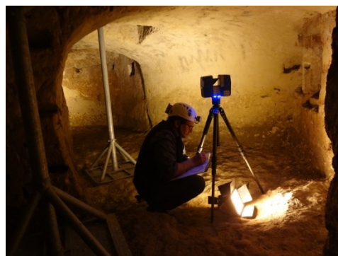
Fig. 3- Sotterranei. Fasi di rilievo eseguito nelle cavità rocciose ipogee con laser scanner 3D
