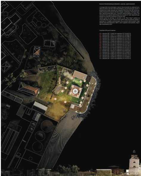
Fig. 2- Rilievo laser scanner e punti di stazione
