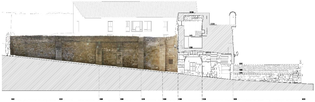
Fig. 13- Alzado y sección de la Puerta. Fotogrametría y dibujo 2D
