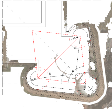
Fig. 5- Sovrapposizione della mesh ottenuta da fotomodellazione e la ricostruzione geometrica. La linea guida è stata la prima dall'alto appartenente al lato esterno del parapetto murario
