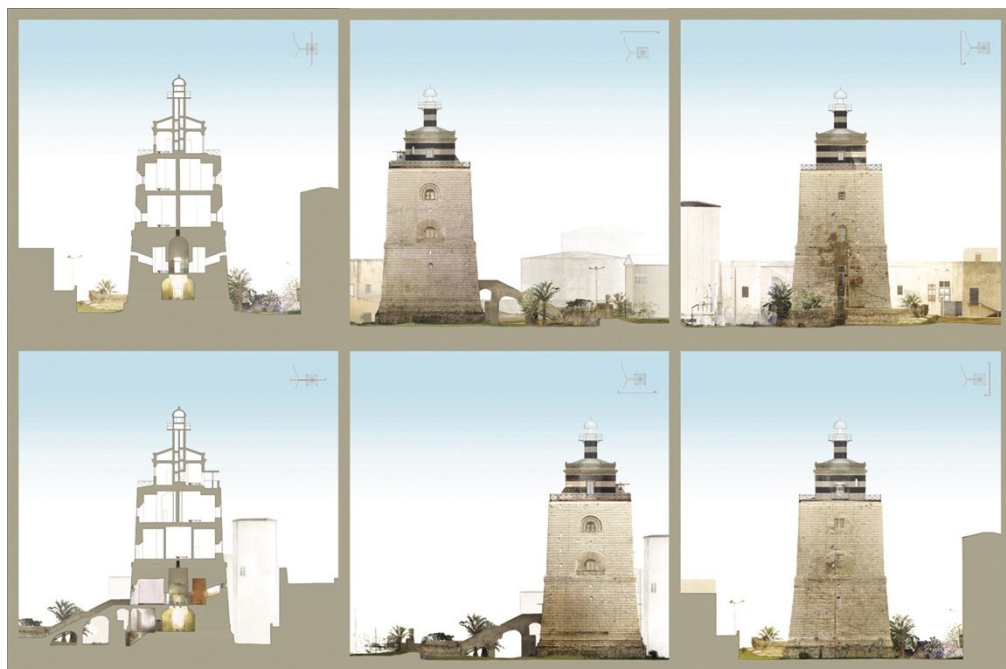
Fig. 4- Rilievo integrato della torre: sezioni e prospetti
