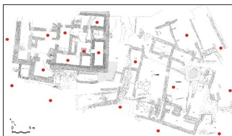
Fig. 8- Rocca di Entella, area del palazzo fortificato e dell'edificio inferiore. In rosso la localizzazione dei 18 punti di scansione
