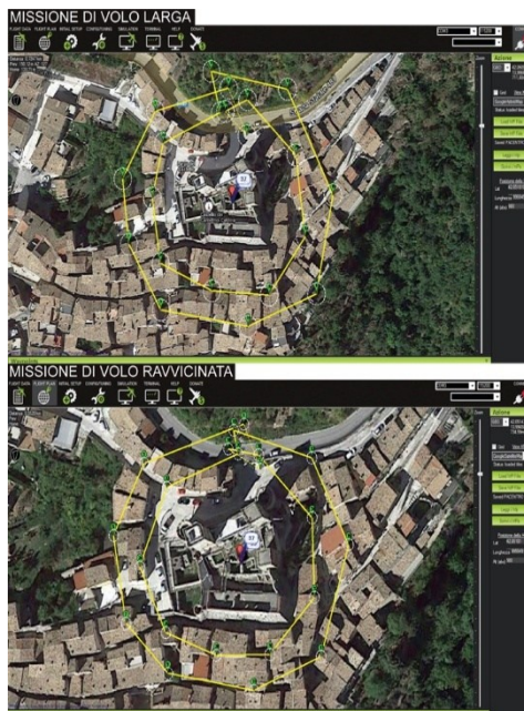
Fig. 3- I due piani di volo effettuati, uno a maglia più larga ed uno a maglia più ravvicinata
