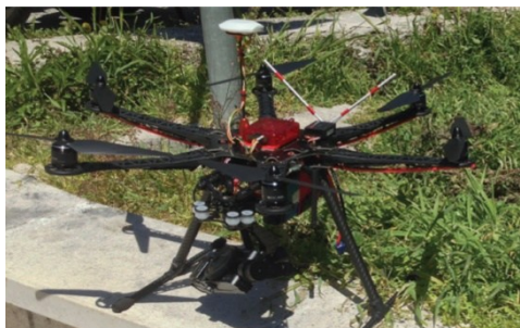
Fig. 2- Drone esacottero utilizzato per il rilievo aereofotogrammetrico del castello
