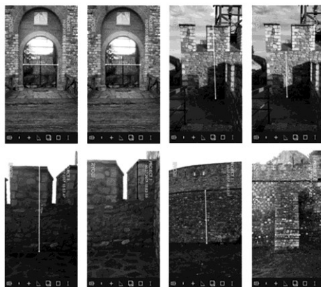
Fig. 5- Fortezza di Kale, immagini e misurazioni ottenute con supporto digitale RYOBI
