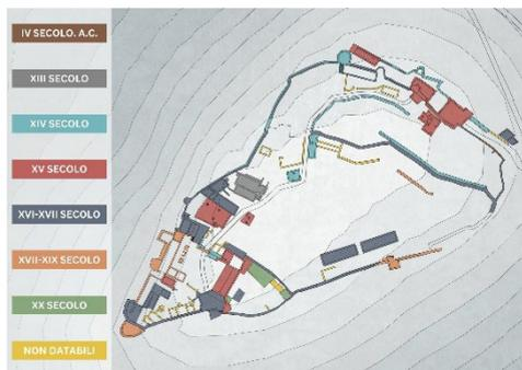
Fig. 2- Fasi di costruzione nei secoli
