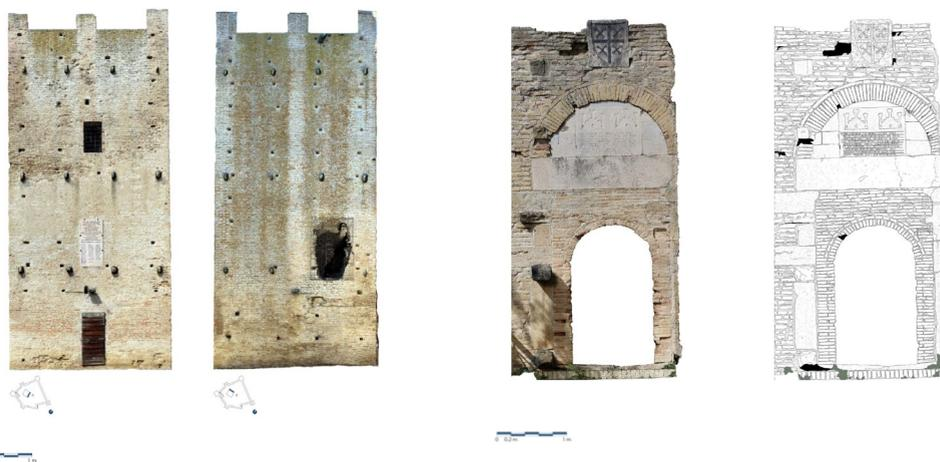
Fig. 5 – Rilievi fotogrammetrici dei fronti sud ed est (elaborazione Marchioli, Mema, Valori 2023).
