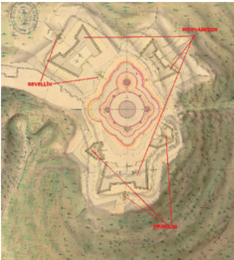
Fig. 3- Juan Ballester Zafra, Ubicación de los hornabeques y revellines sobre el plano IB-05-06, 1740 (Archivo General Militar de Madrid)
