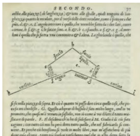
Fig. 6- Denominazioni dei componenti di una fortezza bastionata (Lanteri, 1557, II: p. 87)
