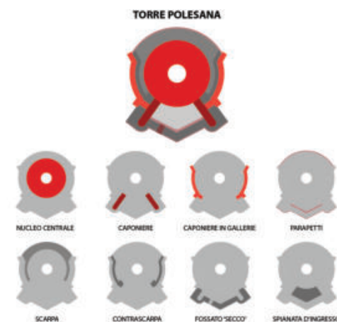
Fig. 3- Composizione di una Torre Polesana (elaborazione grafica di Petar Bašić)
