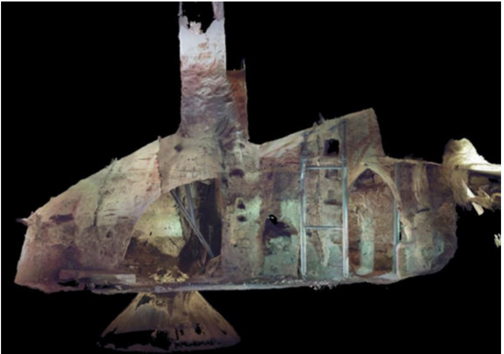
Fig. 7- Cripta. Gemello digitale. In evidenza, le caratteristiche strutturali e l'inserimento delle strutture per la messa in sicurezza dei vani. In basso, un silos parzialmente visibile poiché ancora colmo di materiale (Muscatello & Mitello, 2020)
