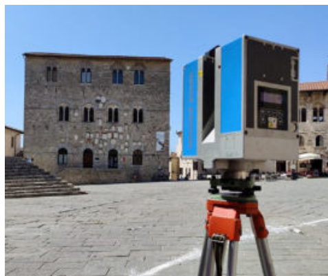
Fig. 4- L'unità laser scanner 3D durante le fasi di rilievo nell'agosto 2021 (foto di G.Verdiani)
