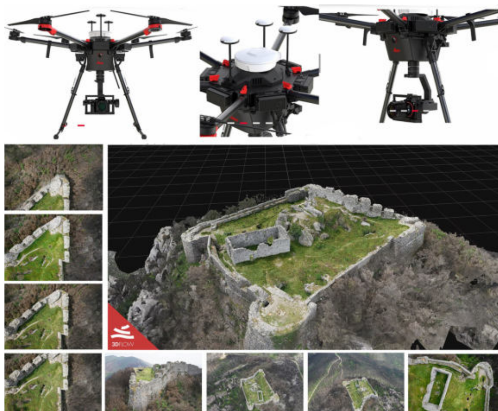
Fig. 3- Elaborazioni del modello tridimensionale mappato ottenuto da fotogrammetria (immagini da drone estratte dal sito Leicageosystem, elaborazione del modello degli autori, 2022)
