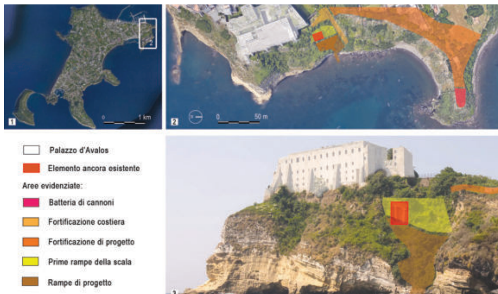
Fig. 2- L'Isola di Procida. Inquadramento satellitare (1 e 2) e presa prospettica dell'area di interesse (3) con in evidenza le aree di probabile collocazione delle strutture di accesso e di difesa al Palazzo d'Avalos (elaborazioni grafiche da immagini Google Earth, 2022)
