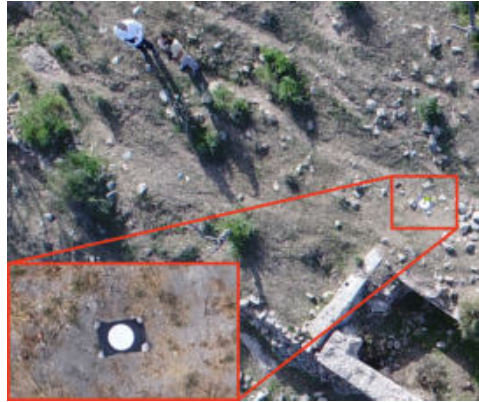
Fig. 4- Dianas empleadas para la georreferenciación del castillejo de Órgiva (Granada) (foto y elaboración gráfica por Jorge Rouco Collazo y José Antonio Benavides López)
