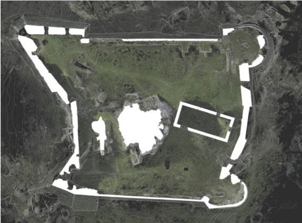
Fig. 5- Pianta della fortezza realizzata utilizzando come sfondo la nuvola di punti e restituendo le curve di livello del terreno circostante (elaborazione grafica degli autori, 2022)
