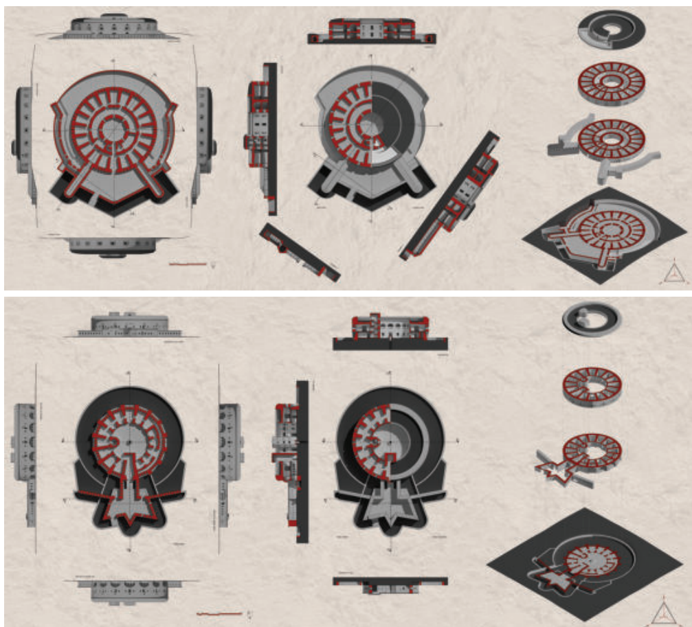
Fig. 7- a) Fort Bourguignon b) Fort San Giorgio: piante piano terra e prospetti; piante piano primo, copertura e sezioni; esploso assometrico (elaborazione grafica di Petar Bašić)
