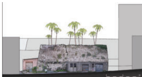
Fig. 9- Rilievo fotogrammetrico del bastione nord-occidentale della cittadella di Palmi (elaborazione grafica degli autori)
