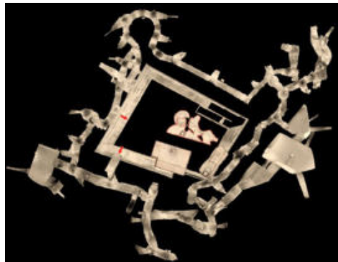
Fig. 2- Rilievo laser scanner 3D del sistema dei camminamenti sotterranei del castello e degli ipogei presenti al di sotto della piazza d'armi. La freccia rossa in alto a sinistra indica l'ingresso al castello. La freccia rossa in basso a sinistra indica uno degli accessi ai sotterranei (Mitello & Muscatello, 2020)
